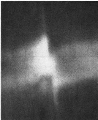
Abb. 17. Kontrast einer Versetzung ( b = \frac{1}{2}[110] ) in einer Glimmerfolie von der Dicke nahe der Extinktionstiefe des (110)-Reflexes, n=1 , Dunkelfeld, (110)-Reflex.
