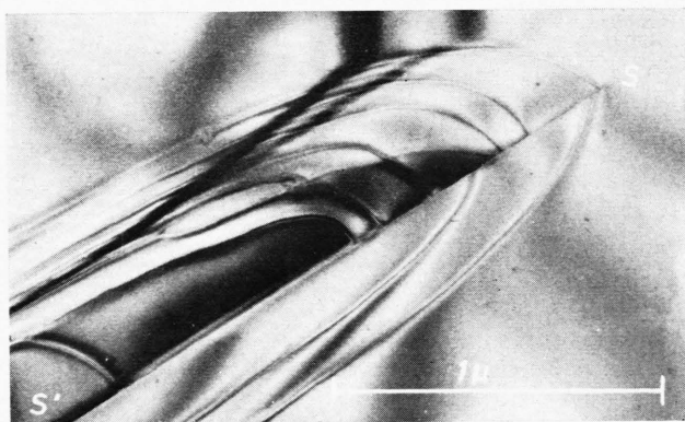
Abb. 1. Riß RR' in Glimmerfolie mit zahlreichen weit in das Material hineingewanderten Versetzungen (Hellfeld).
