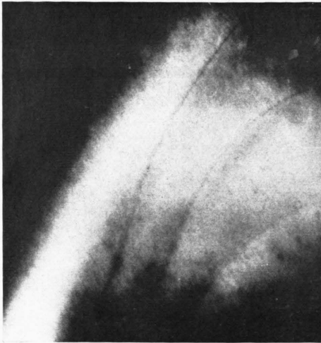
Abb. 8. Versetzungen ( b = \frac{1}{2}[110] ) mit Kontrast entsprechend Abb. 7 b, Dunkelfeld, (110)-Reflex, n=0 .
