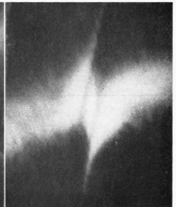
Abb. 20. Wie Abb. 17, Dicke nahe der Extinktionstiefe des (060)-Reflexes, n=3 , Dunkelfeld, (060)-Reflex.
